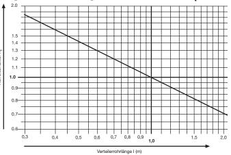
Aus dem Rohrlängen-Korrekturfaktor-Diagramm wird für die Verteilerrohrlänge 0,8 m der Faktor  $K_i=1,12$  entnommen. Anhand der Gleichung  $Q_{0,i}=\frac{Q_0}{2}$ .
